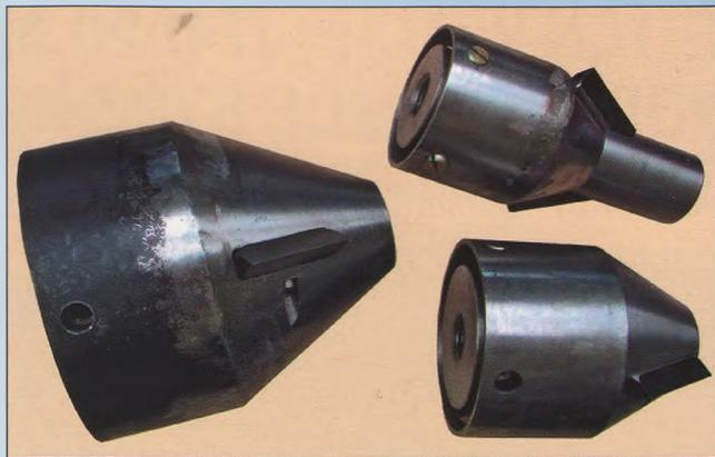
**Расширители-разрушители для колодезной установки АСР-60**
